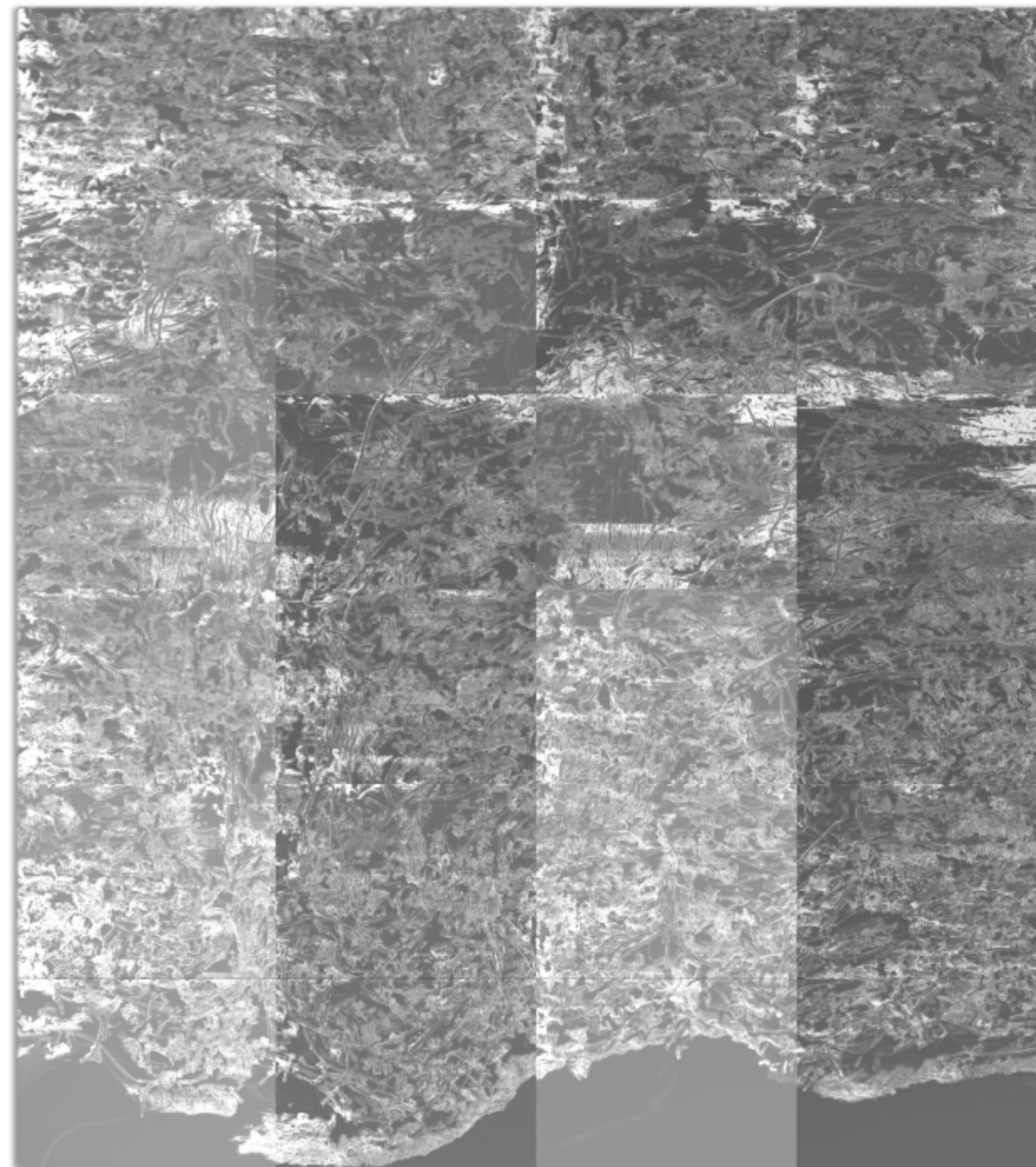
FIGURE 6. 已浸渍可凝结PUD的织物截面SEM复合图
